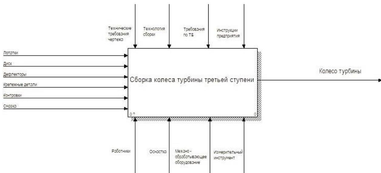
Рисунок 1.5 – Схема процесса сборки рабочего колеса турбины
