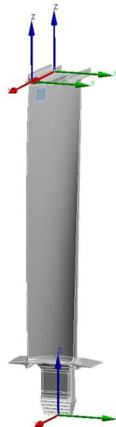
Рисунок 2.18 – Расчётная модель лопатки в программном комплексе ANSYS
