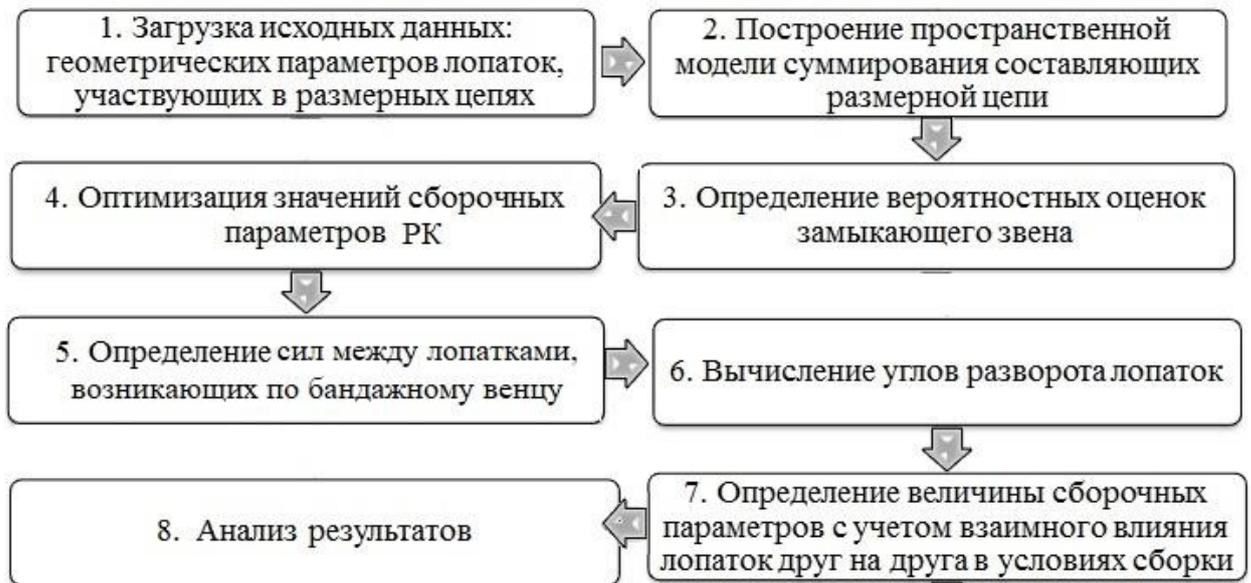
Рисунок 2.21 – Блок-схема алгоритма расчёта геометрических сборочных параметров РК турбины
