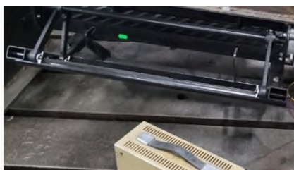
Рисунок 14 – Испытания на ресурс выдвигающейся подножки
