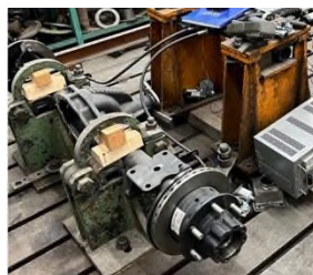
Рисунок 13 – Испытания на ресурс для стояночного тормоза
