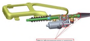
Места обнаружения влаги и коррозии привода стояночного тормоза
