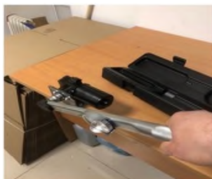
Рисунок 15 – Испытания на удержание заданного момента
