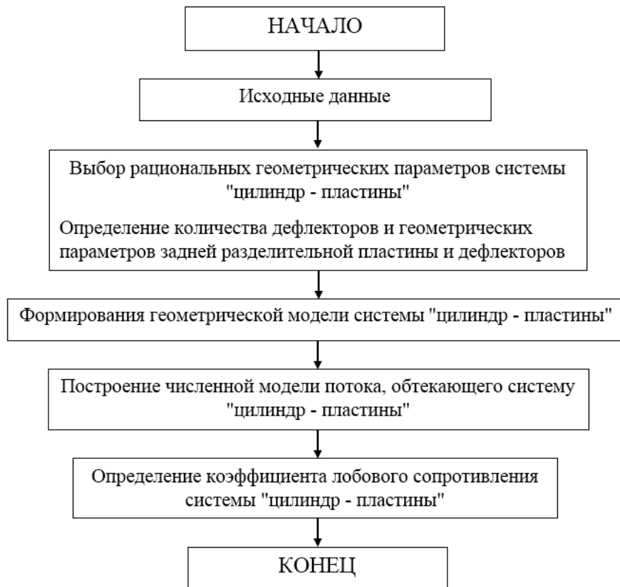
Рисунок 96 – Схема алгоритма метода снижения лобового сопротивления цилиндра при наличии пластин вблизи его поверхности
