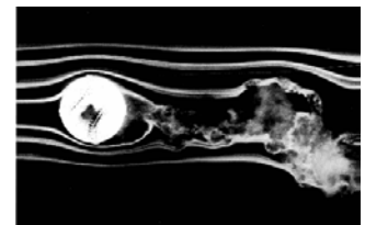
в) подвижные стенки [19-25], снижение сопротивления до 23%
