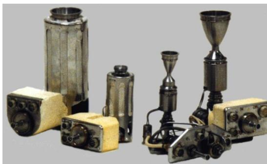
Рисунок 3.6 – Двигатели малой тяги системы ориентации и стабилизации
