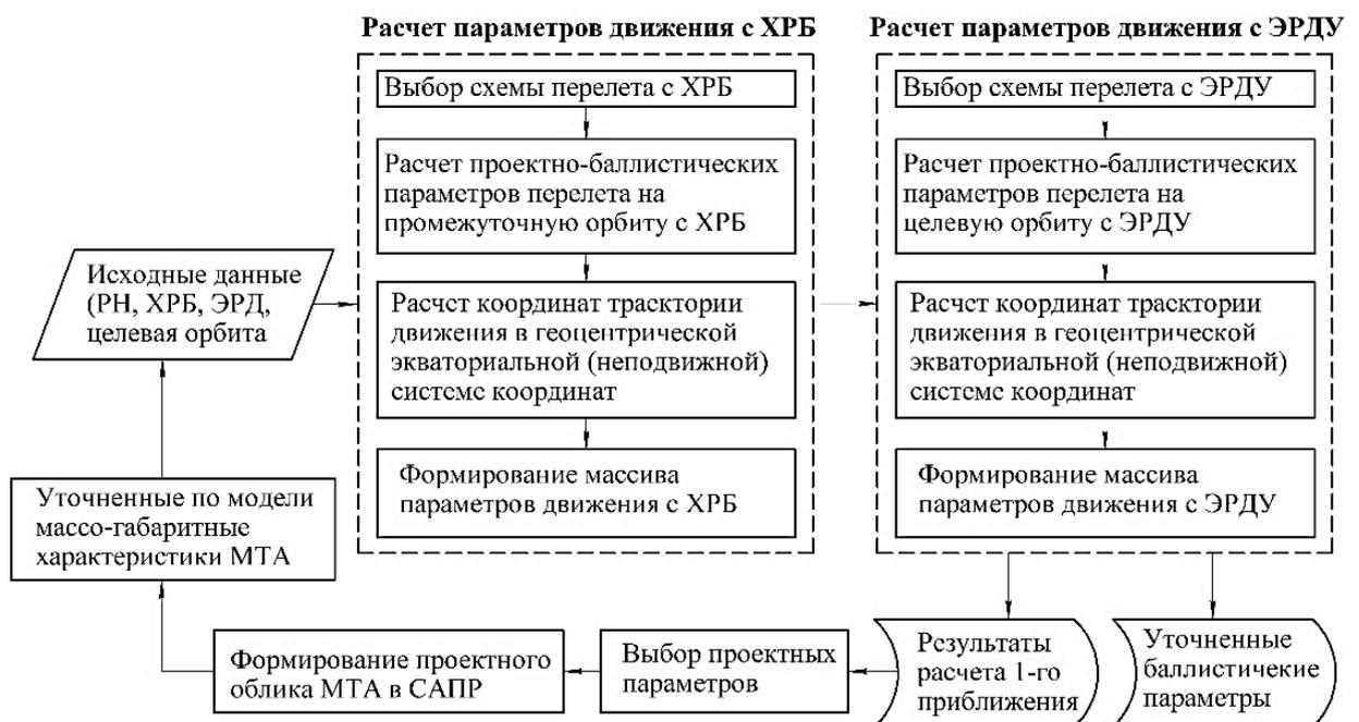
Рисунок 1.8 – Блок схема алгоритма проектирования МТА с ЭРДУ
