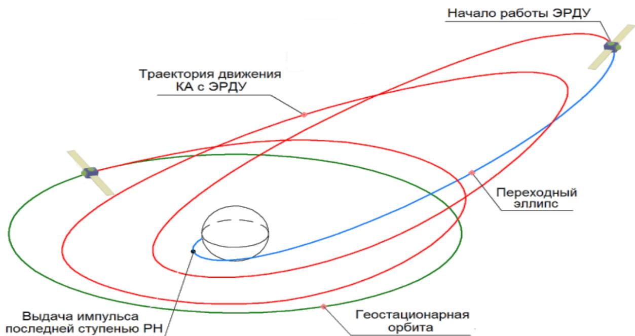
Рисунок 2.5 - Схема выведения с использованием эллиптической промежуточной орбиты [24]
