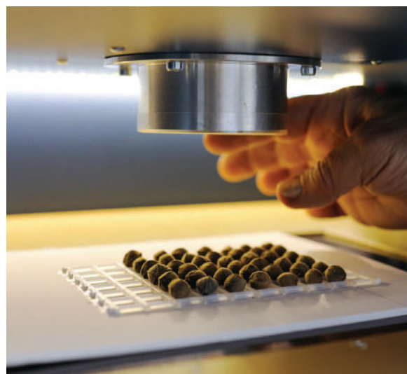
Отбор проходил очень строгий. На фото укладка орешков в рентгеновскую установку
