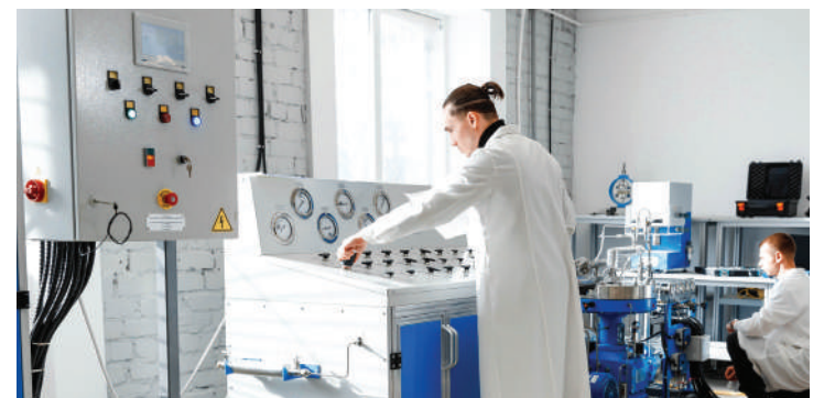
В лаборатории криогенной техники Владислав Боровик настраивает давление на редукторе для отбора пробы ксенона из шар-баллона после заправки
